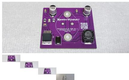
Remplacement du LM338K sur I/O Board version CMS de Stern Pinball
