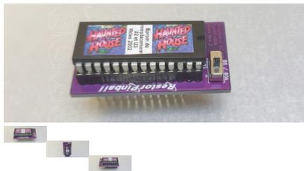
Adaptateur U2 et U3 sur les Cpu Gottlieb, sys80 sys80A
